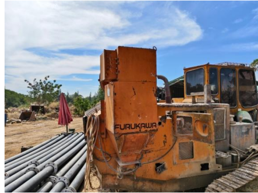
รูปที่ 2.2-6 เครื่องเจาะรูระเบิดที่ใช้งานจะมีอุปกรณ์เก็บฝุ่นติดไว้กับหัวเจาะ
