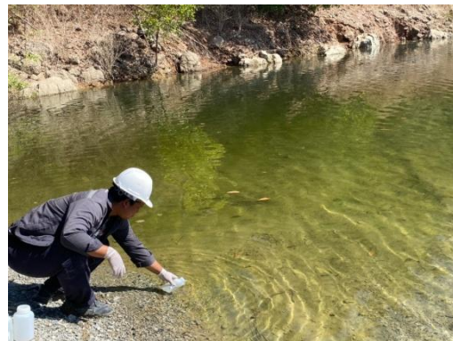
รูปที่ 2.2-15 การตรวจวัดคุณภาพน้ำในบ่อ ตกตะกอน
