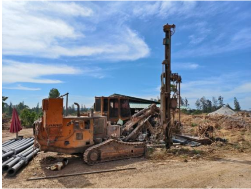
รูปที่ 2.2-6 เครื่องเจาะรูระเบิดที่ใช้งานจะมีอุปกรณ์เก็บฝุ่นติดไว้กับหัวเจาะ
